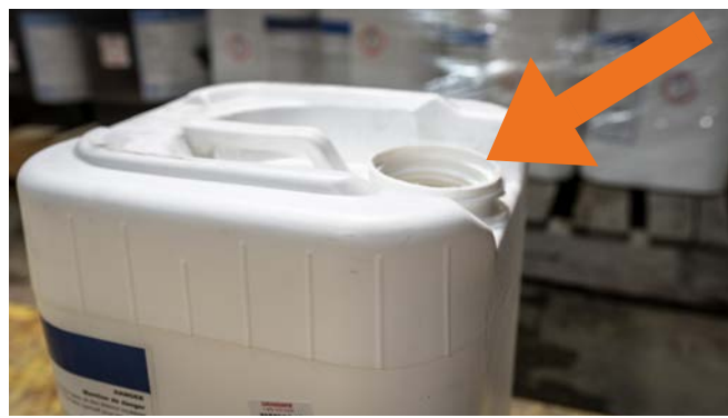
Bung plug(s) missing
